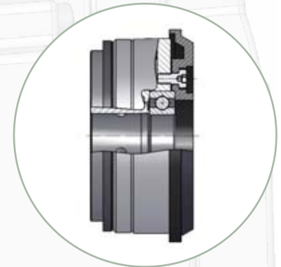
Integración del freno en el lado "B" del escudo de cojinete del motor con longitud acortada
