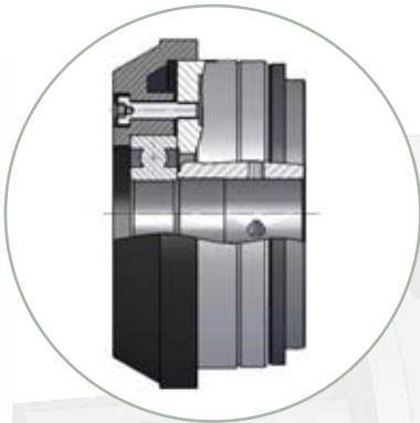
Integración del freno en el lado "A" del escudo de cojinete del motor
